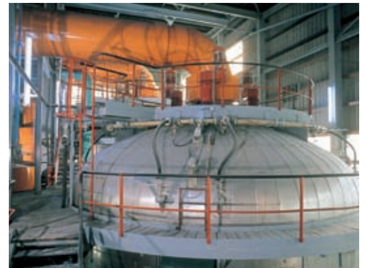
unten In der Grobkorn-Kristallisationsanlage des Werkes Wintershall produzieren acht riesige Gegenstromverdampfer (Kristallisatoren) stündlich 140 Tonnen staubfreies Kaliumchlorid (1976).
