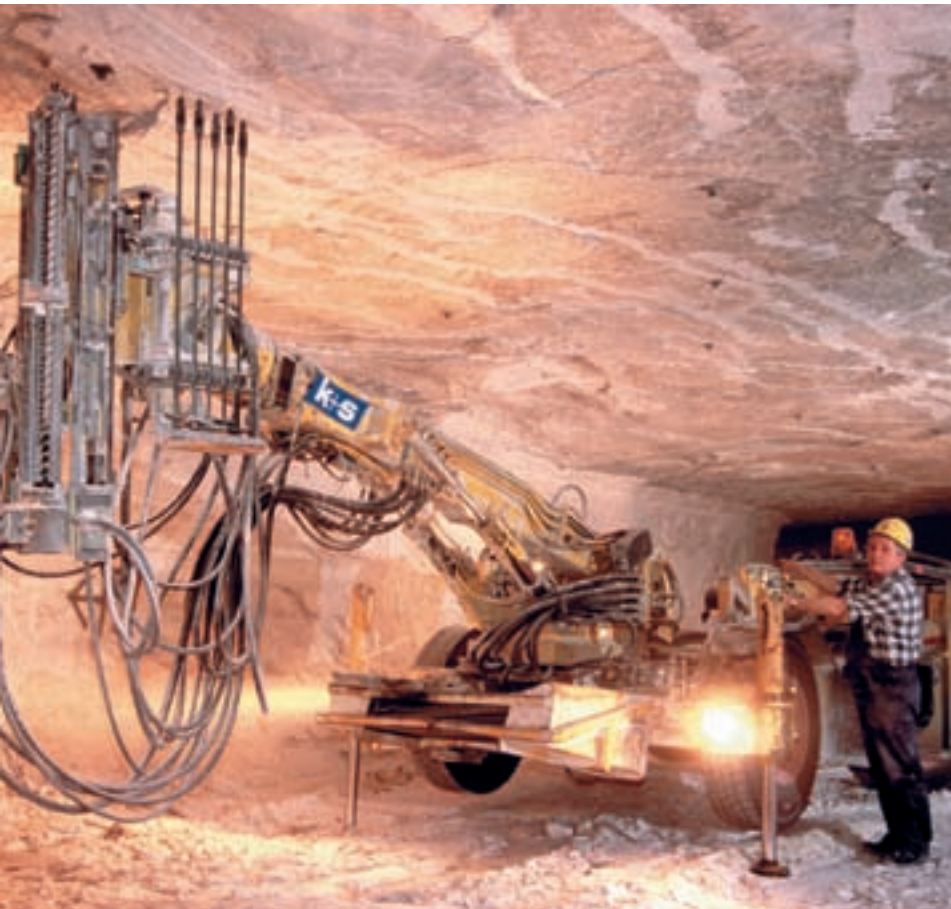
Die kanadische PCS interessierte sich für eine Übernahme der Kali- und Steinsalzwerke von Kali und Salz; im Bild: ein Ankerbohrwagen im Grubenbetrieb Hattorf-Wintershall
